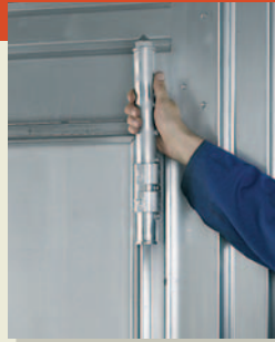
... um 90° drehen, unter den Sturz heben und in die nächste Rastposition bringen.
